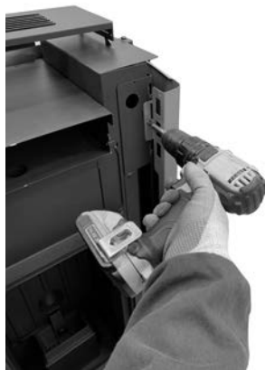
Fig. 31 - Verwijder de schroeven
