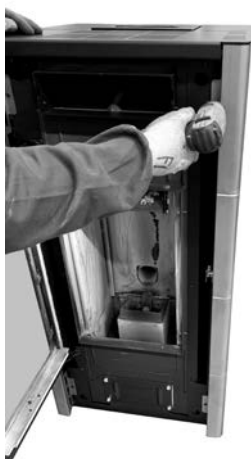
Fig. 26 - Verwijder de schroeven
