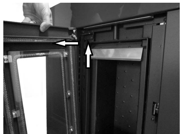
Fig. 19 - Verwijdering van de deur
