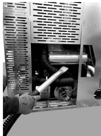
Fig. 107 - Reiniging omgevingsventilator (Mithos³ Plus 12/14)
