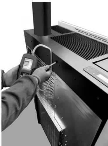
Fig. 88 - Aansluiting digitale drukregelaar (Mithos 3 Plus12/14)
