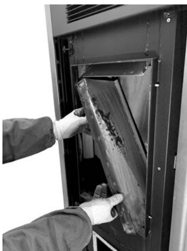
Fig. 98 - Verwijder de zijwanden
