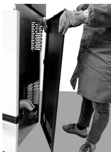
Fig. 46 - Verwijdering van het zijpaneel
