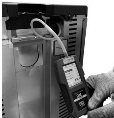
Fig. 87 - Aansluiting digitale drukregelaar (Atena 3 Plus12/14 - Duke 12/14 At - Saba 12/14)
