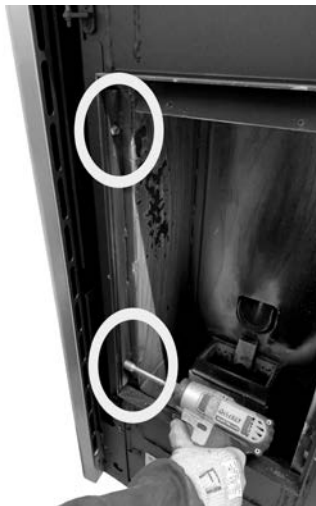
Fig. 95 - Verwijder de zeskantschroeven
