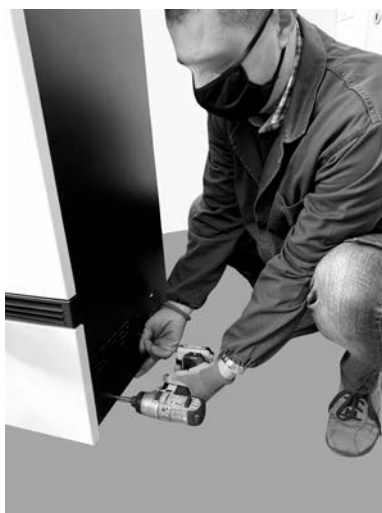
Fig. 45 - Verwijdering van de schroeven
