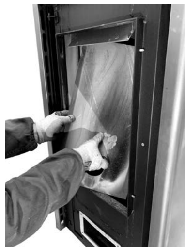
Fig. 99 - Verwijder het achterpaneel van de vuurhaard
