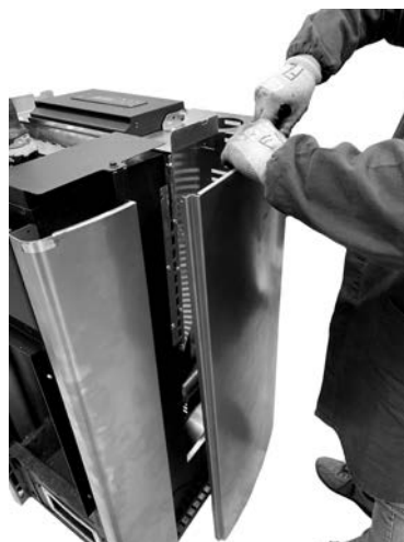
Fig. 29 - Verwijder de zijpanelen
