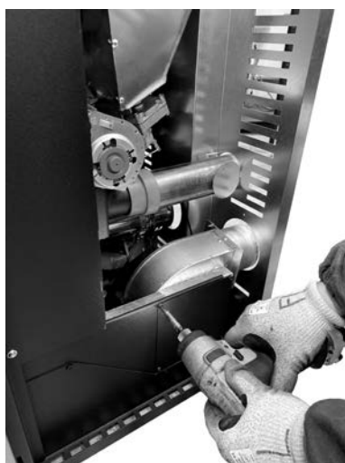
Fig. 60 - Positionering van de buizen voor kanalisering
