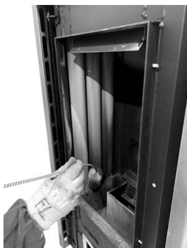
Fig. 100 - Reinig met pijpenwisser
